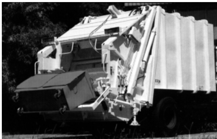
Basculamento de contêineres metálicos
