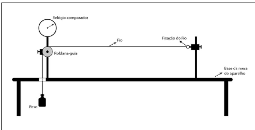
**Figura 1** - Modelo de mesa sugerida para a medição de diâmetro de suturas multifilamentares.
