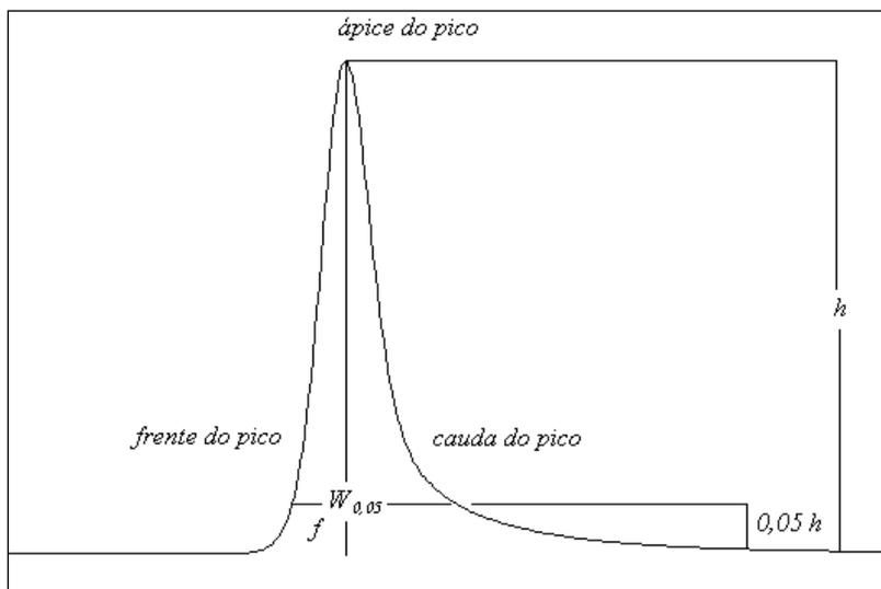
**Figura 2** – Cromatograma representando a assimetria do pico.
