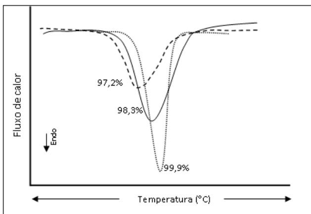
Figura 3 - Exemplo de curvas DSC de uma amostra hipotética com diferentes teores de pureza
