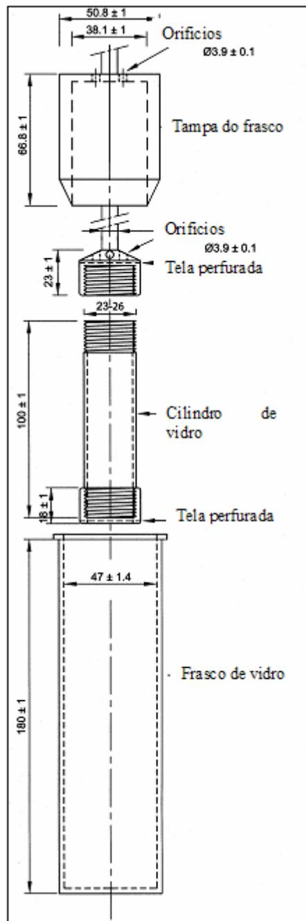
**Figura 3** – Método 3 (Cilindros alternantes).
