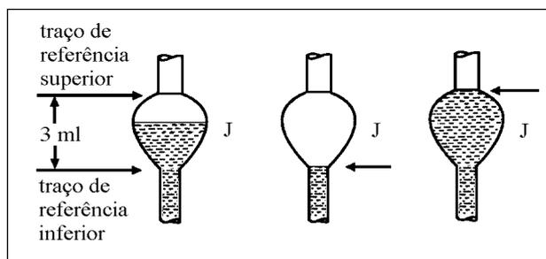
**Figura 2** – Indicação para determinar a velocidade de destilação.
