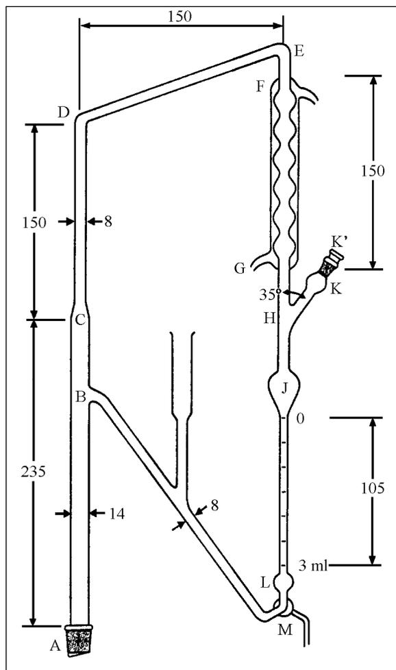
**Figura 1** – aparelho para determinação do teor de óleos voláteis em drogas vegetais pelo processo de destilação por arraste de vapor.
