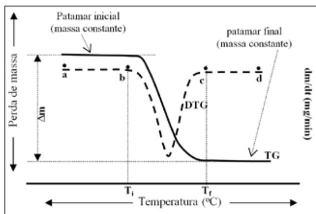
**Figura 1** - Exemplo da curva termogravimétrica e suas medidas.
