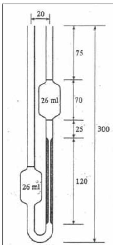
**Figura 1** – Viscosímetro de Ostwald (dimensões em mm).
