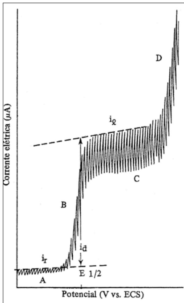
**Figura 1-** Polarograma de espécie eletrorredutível.
