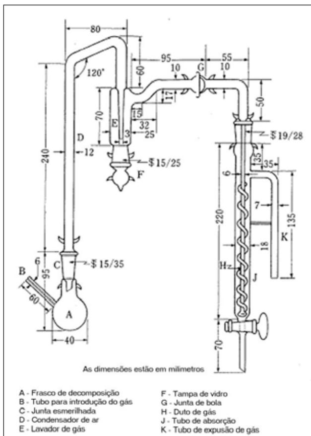
**Figura 1** - Aparelho empregado na determinação da metoxila.
