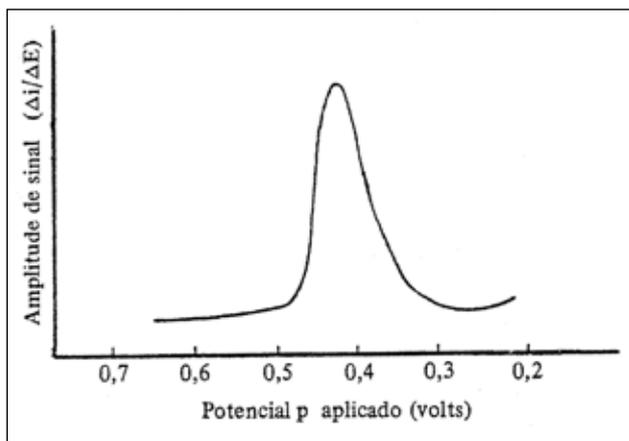
**Figura 3** - Polarograma obtido na polarografia de pulso diferencial.
