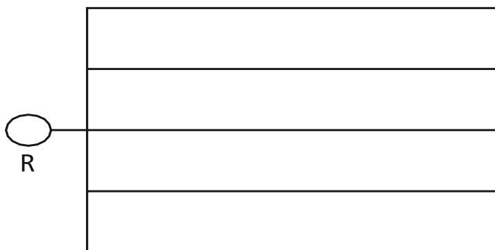
Figura 4.13 – Desenho esquemático de uma rede ramificada tipo grelha
