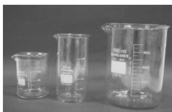
É um tipo de recipiente de uso geral em laboratório, normalmente utilizado para fazer reações entre soluções, dissolver substâncias sólidas, efetuar reações de precipitação e aquecer líquidos. Geralmente graduado, pode ser usado para efetuar medidas imprecisas (normalmente com precisão variante em 5% do marcado). Há dois tipos de *becker*: o de forma baixa e o de forma alta.
