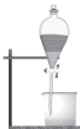
**Decantação:** Utiliza um funil próprio, o funil de decantação, para a separação de misturas onde um dos componentes possui maior densidade, depositando-se no fundo do recipiente.
